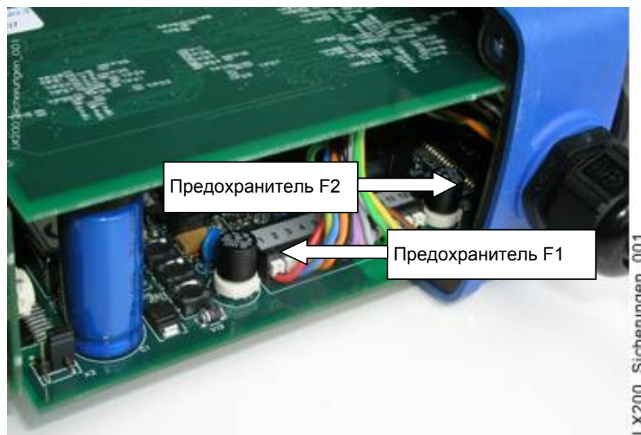
Предохранители MST 250 F1 (слева) = 0,5 А инерц., F2 (справа) = 0,5 А инерц.
