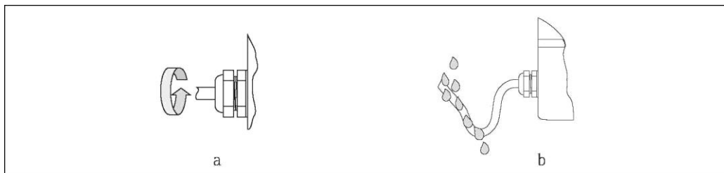
Рис. 47. Инструкции по установке кабельных вводов
